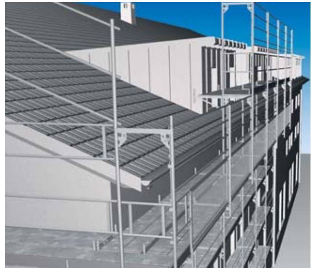
Bild 6 Das Fassadengerüst überragt den Dachrand der Gaube um mindestens 80 cm.
