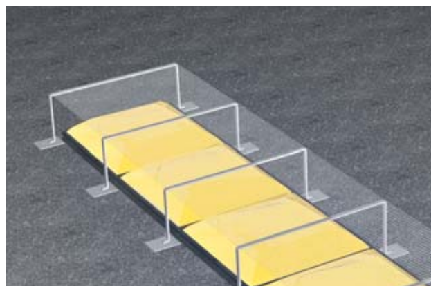
Bild 23 Kunststoffoblicht, mit Kollektivschutz (Gitterabdeckung) gesichert
