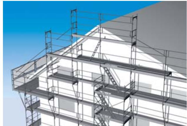
Bild 1 Kollektivschutz in der Bauphase
